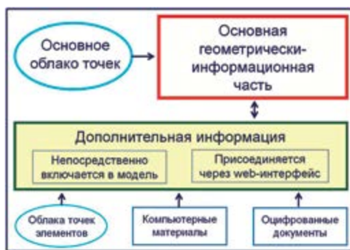
Рисунок 3. Общая схема информационной модели здания или сооружения.
